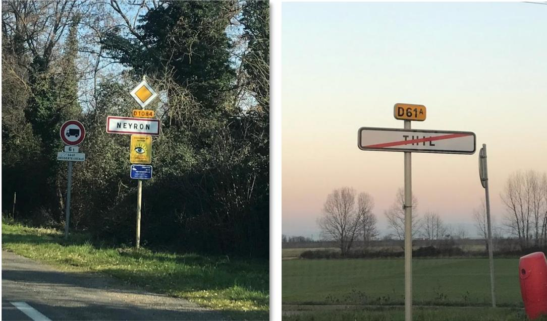
*Panneaux d'entrée (EB 10) et de sortie d'agglomération (EB 20)*
